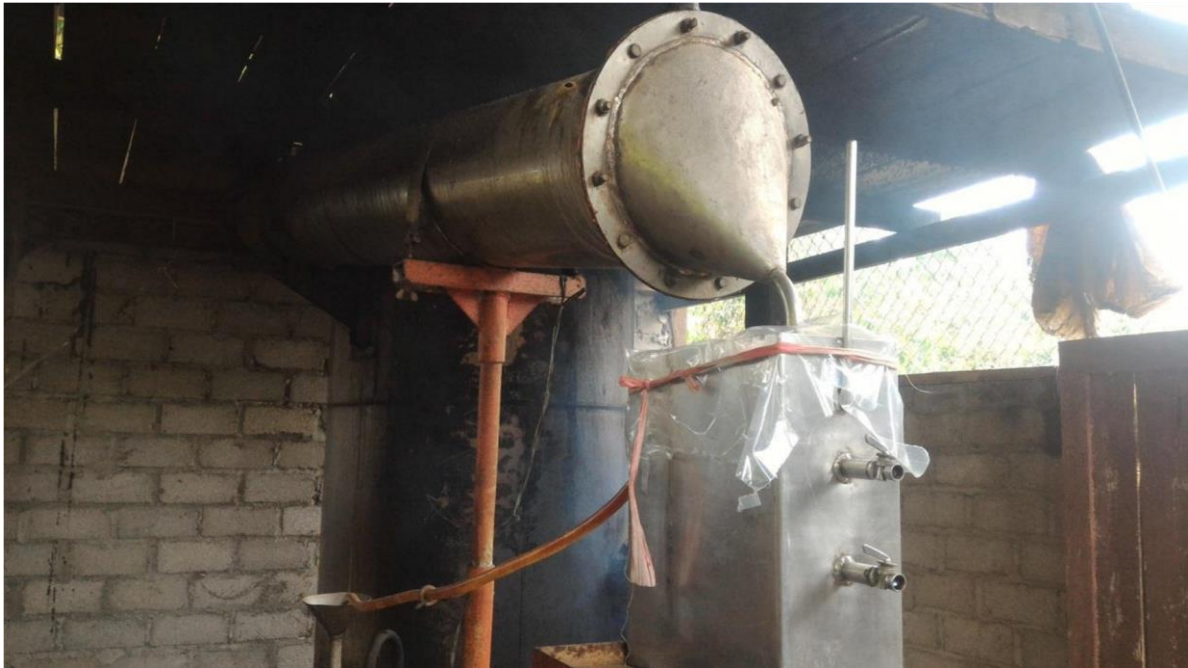
Gambar 11. Bentuk instalasi penyulingan minyak atsiri dari tanaman yang dimiliki Balitro, diperlihatkan ke Petani
