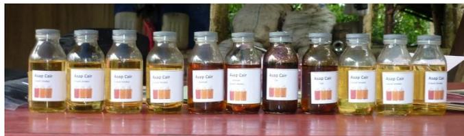
Gambar 5. Asap cair dari tempurung kelapa
