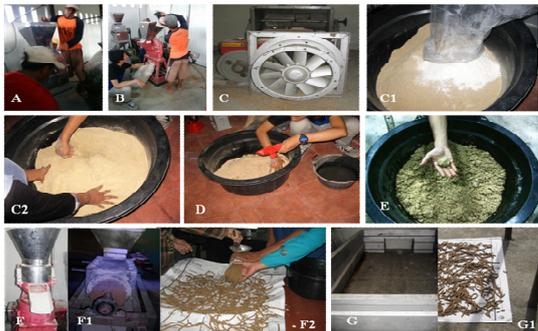
Gambar 4. Metode Pembuatan Ransum Pelet Dengan Campuran Fermentasi Eceng Gondok.
