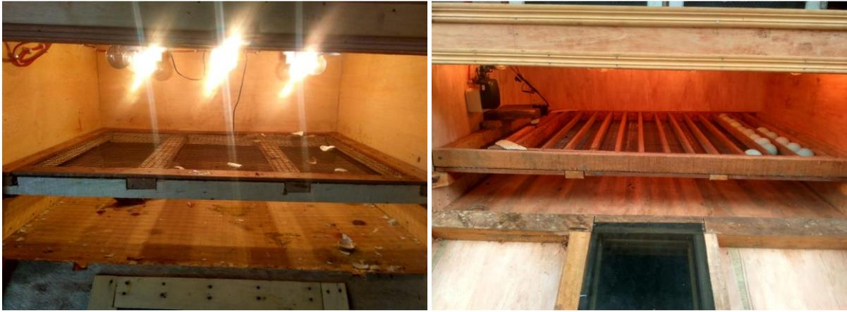
Gambar 4. Mesin tetas tanpa pembalik otomatis (kiri) dan mesin tetas dengan pembalik otomatis (kanan)
