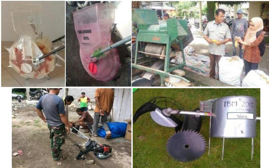
Gambar 8. Peralatan/mesin pertanian yang diintroduksikan (atas: seed planter sebelum dan sesudah modifikasi serta mesin pemipil yang sudah dimodifikasi, bawah: mesin penebas)
