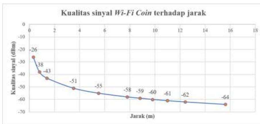
Gambar 13. Hasil pengujian jarak pada sistem *Wi-Fi Coin*
