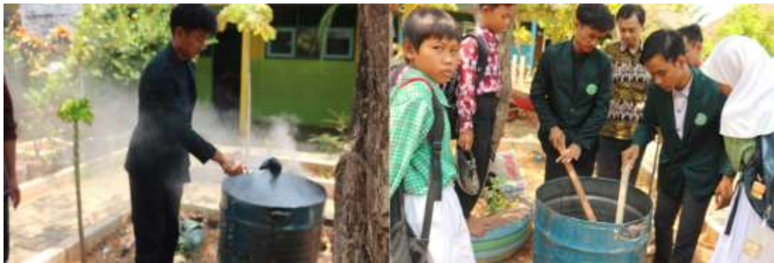
Gambar 3. Kegiatan pembuatan Eco-Paving Block dengan pelarutan sampah plastik
